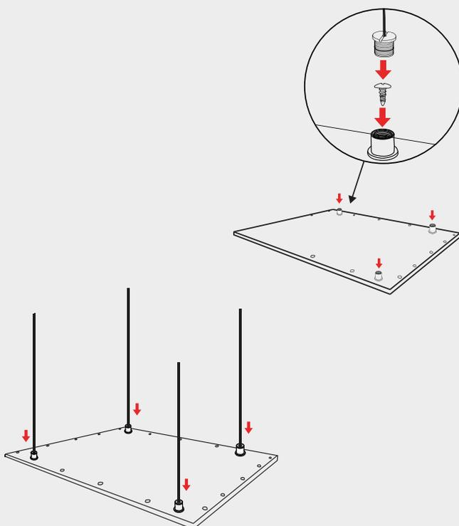
Hier werden vier Schrauben an den Ecken entnommen und die Endhülsen des Panels aufgeschraubt.
