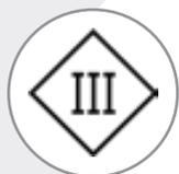
Geräte der Schutzklasse III arbeiten mit einer Schutzkleinspannung. Das bedeutet, dass sie mit Wechselspannung nur bis zu 50 Volt bzw. mit Gleichspannung bis zu 120 Volt funktionieren. Das Anschließen von Schutzleitern ist bei dieser Klasse nicht erlaubt.
