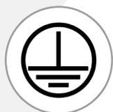
Der Hallenstrahler verfügt über die Schutzklasse 1 und darf niemals ohne den Anschluss an eine Erdung betrieben werden (gelb/grünes Kabel). Ohne den Anschluss der Erdung besteht Lebensgefahr beim Berühren der Leuchte!
