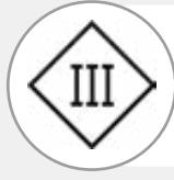
Geräte der Schutzklasse III arbeiten mit einer Schutzkleinspannung. Das bedeutet, dass sie mit Wechselspannung nur bis zu 50 Volt bzw. mit Gleichspannung bis zu 120 Volt funktionieren. Das Anschließen von Schutzleitern ist bei dieser Klasse nicht erlaubt.
